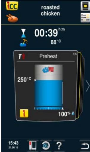
Durch Drücken der iCC Cockpit-Taste oder automatisch nach 10 Sekunden gelangen Sie in das iCC Cockpit. Gerät heizt automatisch vor.
