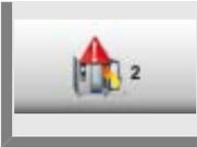
Drücken Sie die **Taste 2. Warnung Beladen: Produkt überprüfen** und stellen Sie mit dem Einstellrad die Zeit bis zur Warnung ein bzw. aus (5 Sek. – 180 Sek.; AUS).
