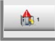
Drücken Sie die **Taste 1. Warnung Beladen: Tür schließen** und stellen Sie mit dem Einstellrad die Zeit bis zur Warnung ein bzw. aus (5 Sek. – 180 Sek.; AUS).
