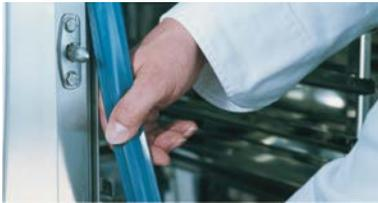
**Die Türdichtung ist in eine Führung am Garraum gesteckt.**
