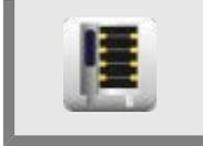
Drücken Sie die Taste und stellen Sie anschließend mit dem Einstellrad den gewünschten Dimmgrad ein in 25% Schritten.
