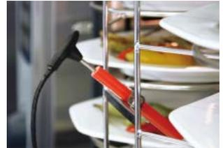
Setzen Sie bei **Finishing®** mit dem Tellerhordengestell den Kerntemperaturfühler in das Keramikrohr am Tellerhordengestellwagen
