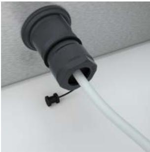
Montieren Sie nun alle Bauteile (beginnend vom Gerät aus) wieder zusammen. Die Bauteile sind handfest und ohne die Hilfe von Werkzeugen zu montieren, damit die Bauteile und Dichtungselemente nicht beschädigt werden.
