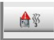
Drücken Sie die **Taste 3. Warnung Garen: Prozess abgebrochen** und stellen Sie mit dem Einstellrad die Zeit bis zur Warnung für den abgebrochenen Garprozess ein bzw. aus (5 Sek. – 180 Sek.; AUS).
