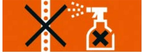
Die Abdeckung der LED-Beleuchtung liegt gut gegen Verschmutzung geschützt hinter der Innen- und Mittelscheibe. Nichtsdestotrotz kann es zur Verschmutzung in diesem Bereich kommen. Öffnen Sie die Innen- und Mittelscheibe, um an die LED-Abdeckung zu gelangen. Nun können die Abdeckungen gereinigt werden. Hierzu nur mit einem Tuch, Schwamm oder Haushaltspapier mit sanftem Druck die Oberfläche der Beleuchtungseinheiten abwischen.
