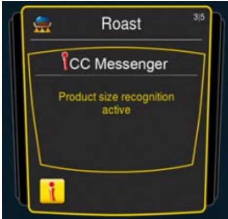
Der iCC Messenger informiert Sie aktiv über die Vorgänge und Anpassungen, die iCookingControl vornimmt. Nach 4 Sekunden verschwindet der iCC Messenger wieder automatisch.
