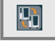
Drücken Sie die Taste **Remote-Bedienung** . Sie befindet sich am unteren Bildschirmrand links, sobald Sie die Funktion aktiviert haben.
