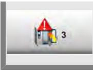
Drücken Sie die **Taste 3. Warnung Beladen: Prozess abgebrochen** und stellen Sie mit dem Einstellrad die Zeit bis zur Warnung über den abgebrochenen Garprozess ein bzw. aus (5 Sek. – 180 Sek.; off).
