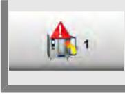
Drücken Sie die **Taste 1. Warnung Beladen: Tür schließen** und stellen Sie mit dem Einstellrad die Zeit bis zur Warnung ein bzw. aus (5 Sek. – 180 Sek.; off).
