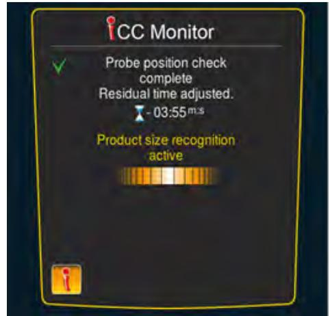
Die Anpassungen werden im Display aufgeführt. Bereits getroffene Entscheidungen sind mit einem grünen Haken markiert. Außerdem werden Sie über die Entscheidungen informiert, die von iCookingControl aktuell getroffen werden und über die Entscheidungen, die noch ausstehen.
