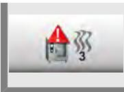
Drücken Sie die **Taste 3. Warnung Garen: Prozess abgebrochen** und stellen Sie mit dem Einstellrad die Zeit bis zur Warnung für den abgebrochenen Garprozess ein bzw. aus (5 Sek. – 180 Sek.; off).
