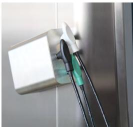
Bitte positionieren Sie die drei Kerntemperaturfühler immer in die dafür vorgesehene Halterung, um die Verletzungsgefahr zu vermeiden.
