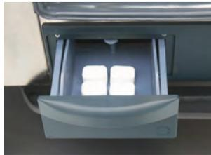
**Tischgeräte:** Angezeigte Menge Care-Tabs-Packungen in die Schublade füllen.
