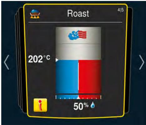
Die i-Taste erscheint, sobald eine Entscheidung getroffen wurde bzw. eine Einstellungsanpassung im Hintergrund abläuft. Durch Drücken der i-Taste bzw. durch Drücken auf das zentrale Einstellrad, wird im iCC Cockpit der iCC Monitor aufgerufen.
