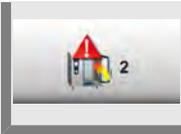
Drücken Sie die **Taste 2. Warnung Beladen: Produkt überprüfen** und stellen Sie mit dem Einstellrad die Zeit bis zur Warnung ein bzw. aus (5 Sek. – 180 Sek.; off).
