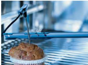
Verwenden Sie die Positionierhilfe für die Möglichkeit, dass sich der Kerntemperaturfühler selbstständig aus dem Gargut lösen kann (z. B. Lebensmittel mit weicher Konsistenz oder geringer Dicke).
