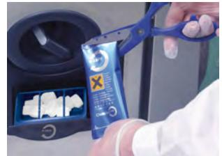
**Standgeräte:** Angezeigte Menge Care-Tabs-Packungen in die Klappe füllen.
