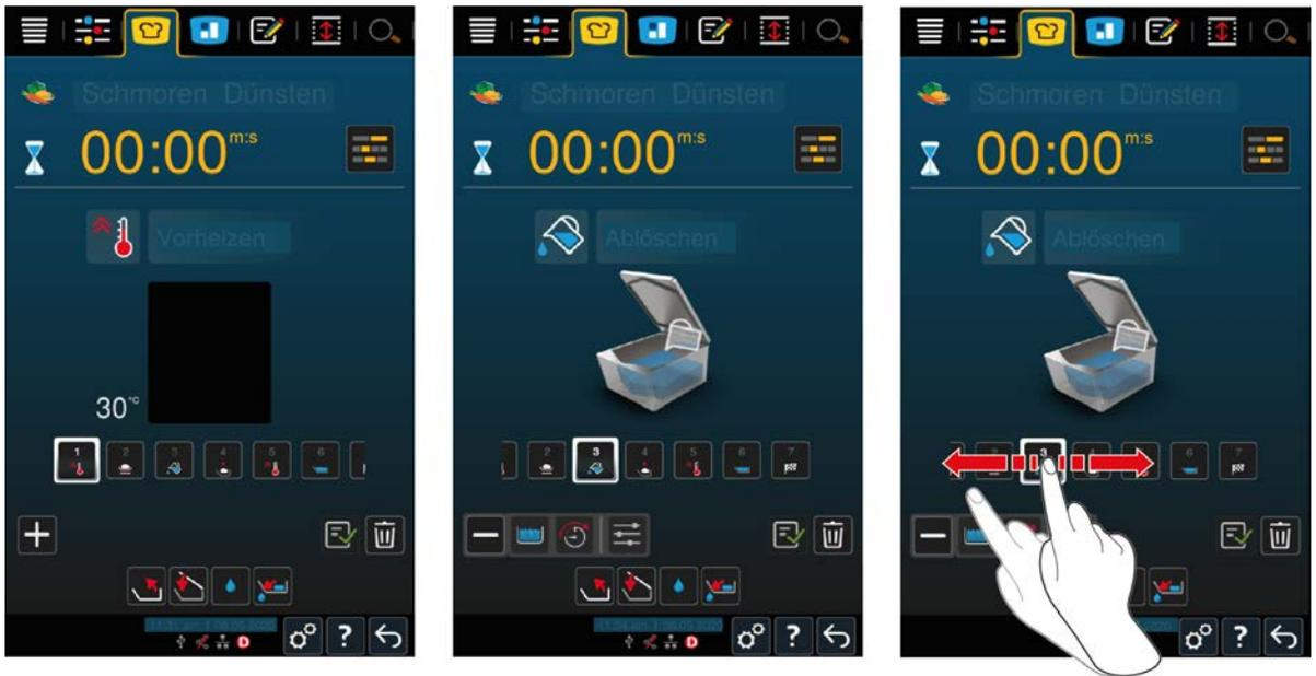
Cuando inicia un proceso de cocción inteligente, la visualización cambia rápidamente en el cockpit. Aquí aparecerán todos los pasos de cocción que termine el proceso de cocción inteligente uno tras otro. Aparece señalado el paso de cocción activo. Los pasos de cocción situados en el futuro aparecen en gris. Cuando finaliza un paso de cocción, aparece automáticamente el paso siguiente.
