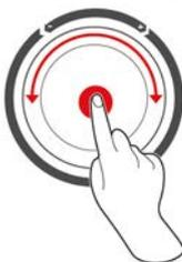
En lugar de con estos gestos, también puede modificar los ajustes de configuración girando la rueda de ajuste central. Puede interrumpir acciones tales como la apertura automática de la tapa de la cuba, la bajada automática de la cuba o el llenado de agua automático mediante la rueda de ajuste central. Además, puede usar la rueda de ajuste central para desactivar la señal acústica que sonará cuando el equipo requiera su intervención.
