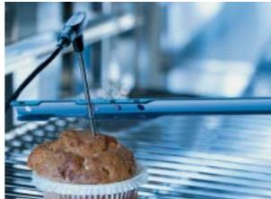
Válgase del posicionador para evitar que la sonda térmica se suelte por sí sola del alimento durante la cocción. Esto puede ocurrir, por ejemplo, cuando se preparan alimentos de poca consistencia o bajo espesor.
