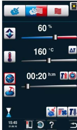
Accionando la tecla "Vapor", "Combinación" o "Calor seco", se accede al modo **Vaporizador combinado**.
