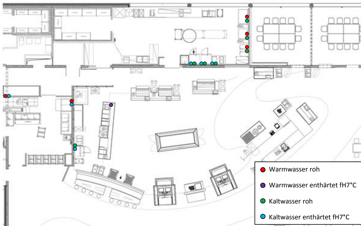
Bild 3-16: Die gemessenen Wasseraustrittsstellen in der Küche
